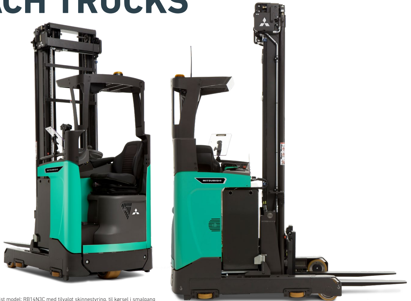
Vist model: RB14N3C med tilvalgt skinnestyring, til kørsel i smalgang
