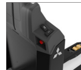
Knap i bagstøtte til "walk beside" -funktion til løft/sænkning
