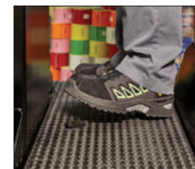
Fodpedal til sænkning af føreplatform
