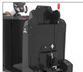
Automatisk kobling med ergonomisk oplåsningshåndtag.
