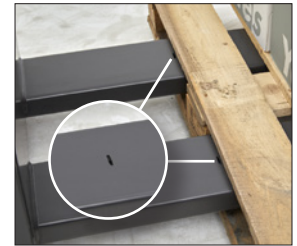
Indikation om palle på tværs af gaffler
