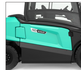
Sidelåge til batterirum
